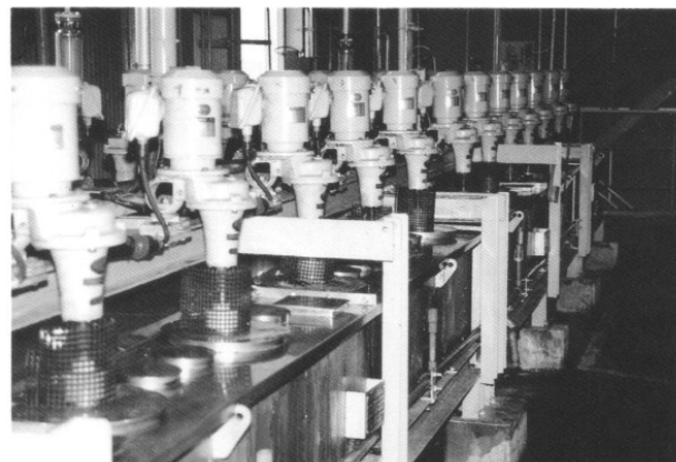
図：溶媒抽出法による向流多段抽出装置
