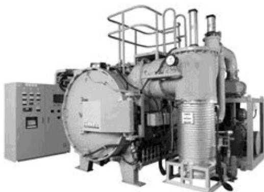
バッチ式焼結・熱処理炉の一例
