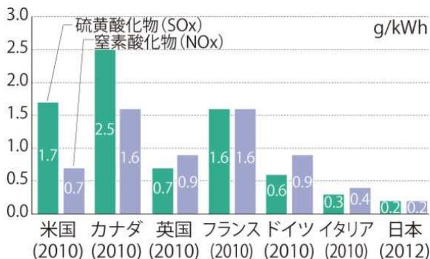
火力発電における発電電力量あたり SO<sub>x</sub>、NO<sub>x</sub> 排出量の国際比較
