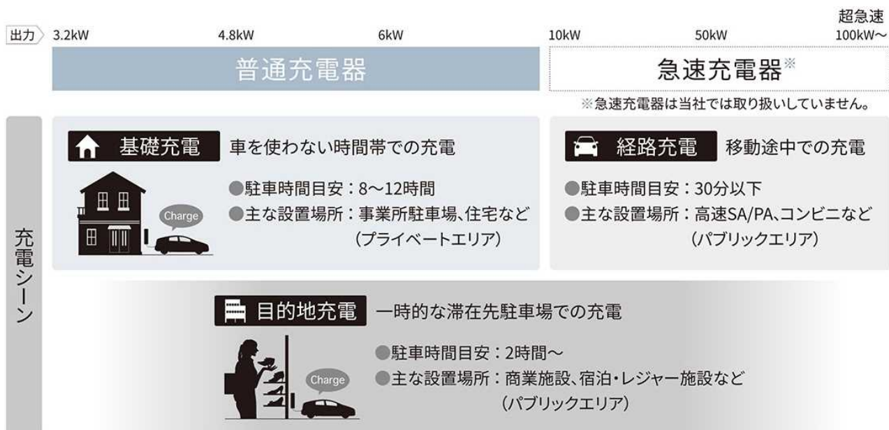
充電シーンによる分類（日東工業 HP）
