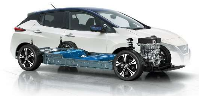
日産リーフの床下バッテリーパック
