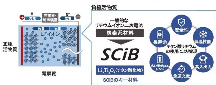
負極にチタン酸リチウム(LTO)を採用したリチウムイオン二次電池 LTO負極を使うことで多くのメリットを実現
