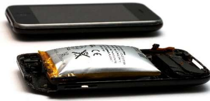
短絡により膨張したリチウムポリマー電池
