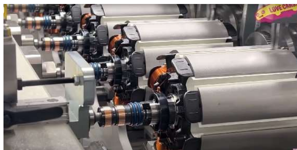
日産・アリアのローター巻線工程
